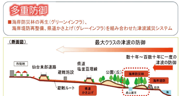
図2 多重防御の断面イメージ
