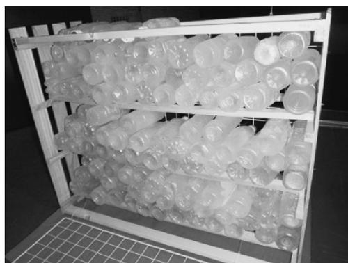
写真1 簡易ケーシング型冷凍ペットボトル冷房装置
