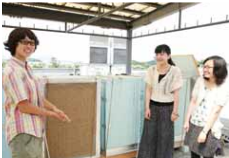
屋上のボックスモデルで土壁の室内空気環境の影響を研究。
